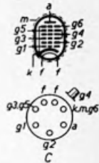
Schakeling en voet van de eerste octode mengbuis AK1
